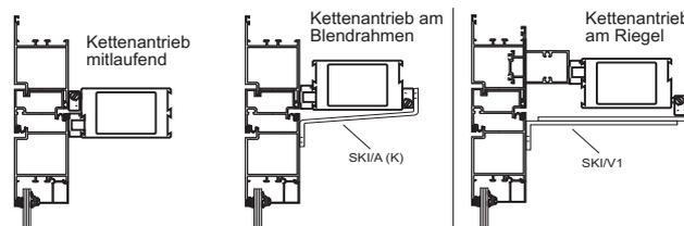
Flügelüberschlag 0 - 12 mm (bei Flügelüberschlag 13 - 22 mm Abstandsböckchen einsetzen)
