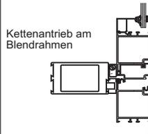
Flügelüberschlag 0 - 12mm (bei Flügelüberschlag 13 - 22 mm Abstandsböckchen einsetzen)
